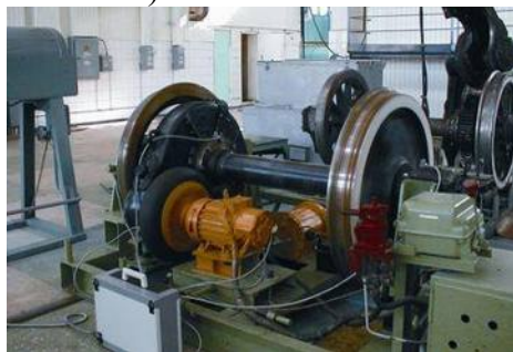
Рисунок 1 – Вибродиагностика в депо
