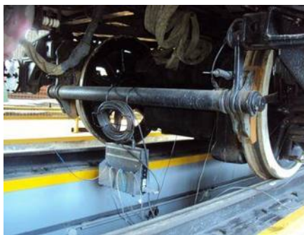
Рисунок 2 – Вибродиагностика с помощью системы КОМПАКС®-ЭКСПРЕСС
