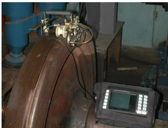
Рисунок 2 – Ультразвуковой метод контроля с помощью устройства УД2-70
