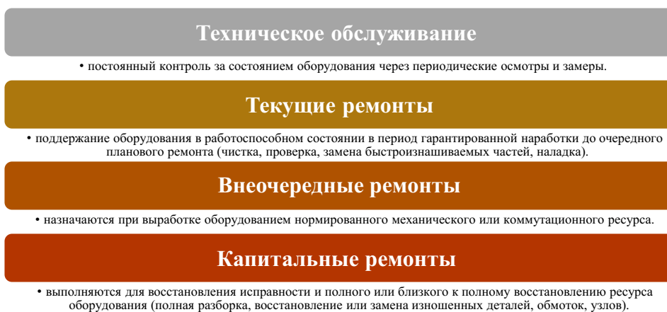
Рисунок 1 – Виды обслуживания подстанций
