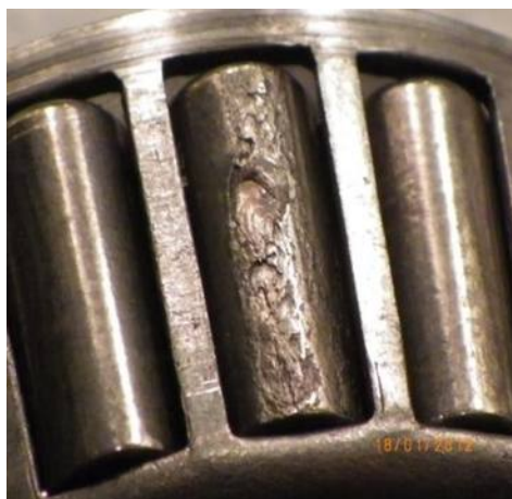
Рисунок 2 – Следы «интенсивного проворота» заклинившего подшипника под адаптером
