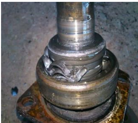
Рисунок 1 – Следы механического повреждения подшипника
