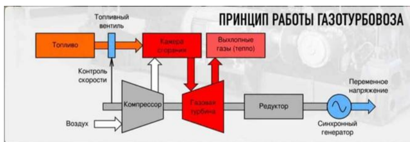
Рисунок 2 – Принцип работы газотурбовоза Г1-01
